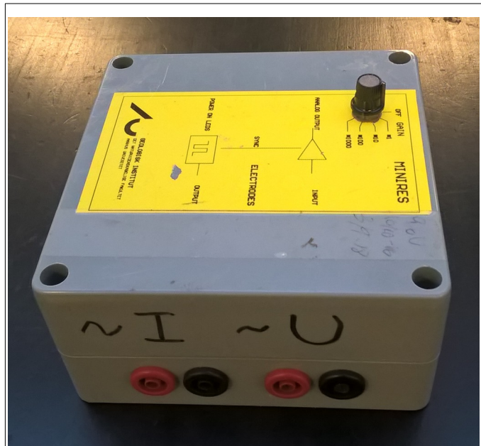
Illustration 5: Spændingskilde, der sender en vekselspænding ud via de to stik til venstre på billedet. De skal forbindes til de røde ledninger, og der skal tilkobles et amperemeter i serie. De gule ledninger skal tilsluttes de to ledninger til højre på boksen. Udstyret er lånt fra geoinstrumentbank.dk .
